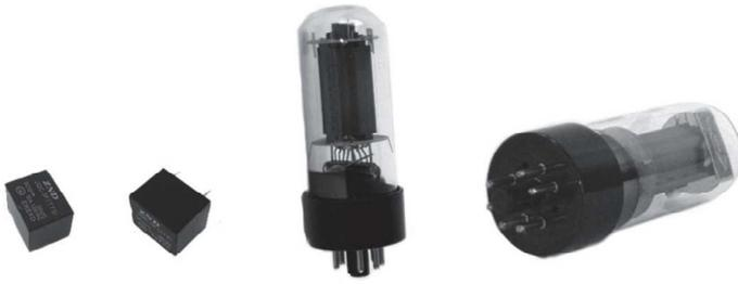
**Figura 2.2: Relés (E) e Válvulas (D)**
