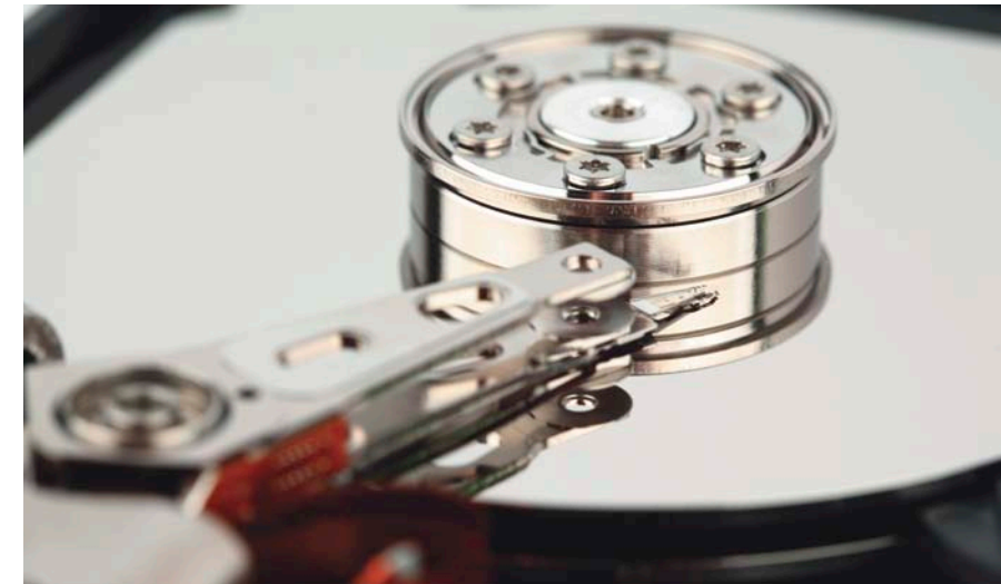
Figura 1.52 Cabeçote de gravação magnética de HD.
