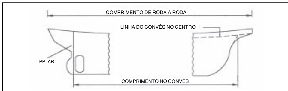
Fig. 2-14 – Comprimento no convés e comprimento de roda a roda
