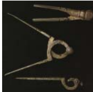
Compasso de ponta-seca e dois compassos de cartear - um completo e parte de outro - até hoje usados para comparar medidas e distâncias sobre as cartas náuticas.
