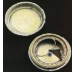
Relógio de sol, de algibeira, preciso somente na latitude para a qual foi construído. O estojo de marfim continha, originalmente, a rosa, a agulha magnética e a escala horária com gnômon rebatível, de bronze.
