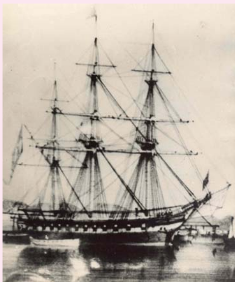
Fragata Imperatriz , navio com 54 canhões que operou na Marinha Imperial entre 1824 a 1845. Com 46 metros de comprimento e 12,20 metros de boca, era um exemplo típico dos grandes navios que formavam a Esquadra brasileira no Primeiro Reinado.
