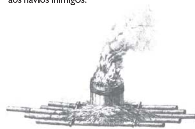
3 Brulote – Embarcação carregada de matérias inflamáveis e explosivas destinada a levar fogo aos navios inimigos.
