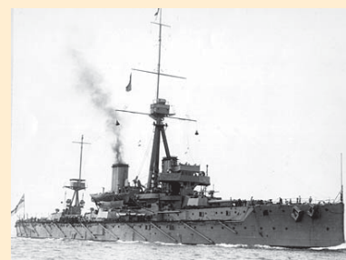
4 Encouraçado Dreadnought – Idealizado pelo Almirante Lorde Fisher, Primeiro Lorde do Mar da Marinha britânica. Tinha como características forte armamento com canhões de até 12 polegadas, grande deslocamento, motores de propulsão mais eficientes e poderosa blindagem.
